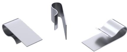
Vor dem Aufbringen des Säurekittes werden auf jede Muffe des Keramikrohres drei Edelstahlklammern aufgesteckt, die als Zentrierhilfe zur leichteren Rohrmontage dienen.
