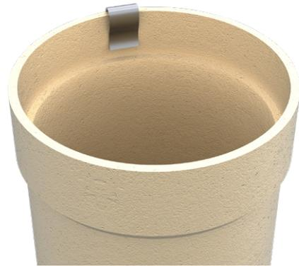
Vor dem Aufbringen des Säurekittes werden auf jede Muffe des Keramikrohres drei Edelstahlklammern aufgesteckt, die als Zentrierhilfe zur leichteren Rohrmontage dienen.
