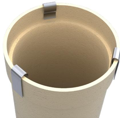
Die Klammern werden mit der kurzen Seite nach innen gleichmäßig auf der Rohrmuffe verteilt, erst dann wird der Säurekitt nach Pos. 4 aufgebracht und die Rohre zusammengesteckt.
