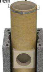
Stellen Sie einen weiteren Leichtbeton Mantelstein auf und montieren als nächstes die Putztüröffnung mit Kondensat Sockel auf dem Auflagekreuz.
