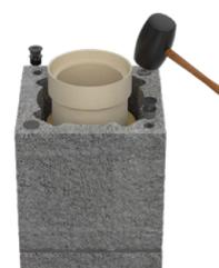
Bei Schornsteinen mit einer leichten Faserzementplatte montieren Sie die mitgelieferten Kunststoffdübel in die 4 Öffnungen von dem Leichtbetonmantelstein.
