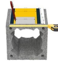
Mit Hilfe der Schablone, die Bestandteil der Lieferung ist, zeichnen Sie auf den Leichtbeton Mantelsteinen die Öffnungen für die Revisionstür, die Putztüröffnung und den Rauchrohranschluss ein.
