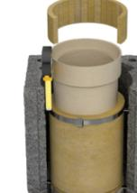
Bei dem Anbringen der letzten Mineralwolle ist darauf zu achten, dass ein Abstand von 5 bis 8 cm zwischen der Abdeckplatte und der Mineralwolle besteht, so dass die Luftzirkulation gewährleistet wird.
