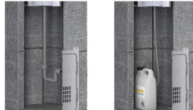
Abhängig von der durch Sie gekauften Schornsteinvariante bestehen 2 Möglichkeiten der Kondensatabführung – Mithilfe von einem Syphon oder mit dem Kondensatsammelbehälter.
