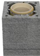
Bevor Sie das nächste Keramikrohr montieren, müssen 3 Zentrier Klammern pro Rohr mit der kürzeren Seite nach innen angebracht werden. Die Verbindungsfugen glätten und reinigen Sie mit dem mitgelieferten Säurekitt Reiniger / Fugenglätter.
