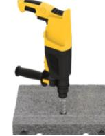
Bohren Sie eine Öffnung mindestens 10mm von der Unterkante des Leichtbeton Mantelsteins. Die Bohrung muss einen Durchmesser von mindestens 30mm haben, durch die Öffnung wird der Schlauch für den Kondensatablauf geführt.
