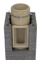
Montieren Sie jetzt die Putztüröffnung auf dem Kondensat Sockel in dem Mantelsteinen mit der zuvor vorbereiteten Öffnung. Die Abstandshalter montieren Sie alle 66 cm.
