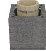
Montieren Sie die weiteren Leichtbetonmantelsteine, Keramikrohre und Abstandshalter bis zum Erreichen der gewünschten Schornsteinhöhe. Die Abstandshalter montieren wir nach dem das Keramikrohr in den Leichtbeton Mantelstein eingeführt wurde.
