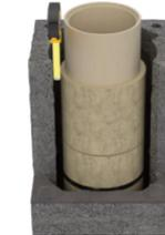
Bei dem Anbringen der letzten Mineralwolle ist darauf zu achten, dass ein Abstand von 5 bis 8 cm zwischen der Abdeckplatte und der Mineralwolle bestehend bleibt, so dass die Luftzirkulation gewährleistet wird.
