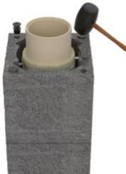
Bei Schornsteinen mit einer Leichten Faserzementplatte montieren Sie die mitgelieferten Kunststoffdübel in die 4 Öffnungen von dem Leichtbeton Mantelstein.
