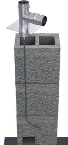
Nach Erreichen der notwendigen Höhe montieren Sie als nächsten Schritt den Rauchrohranschluss in dem davor zugeschnittenen Mantelstein und fahren weiter fort mit der Montage der nächsten Leichtbetonmantelsteine, hierzu ist unbedingt der Punkt 6 der Aufbauhinweise aus der mitgelieferten Montageanleitung zu beachten.
