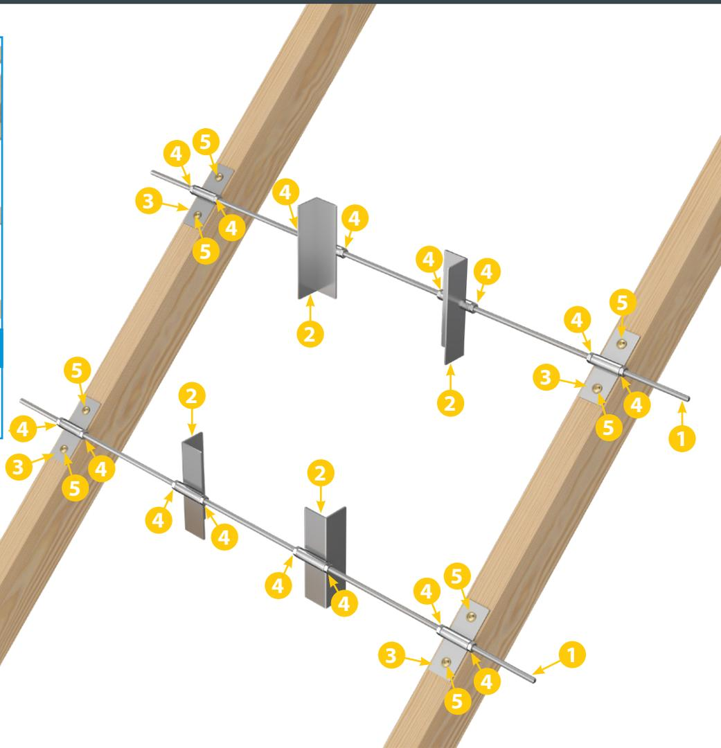
Wenn Ihr Schornstein mehr als 1,5m über das Hausdach übersteht, muss dieser entsprechend Verstärkt werden, dieses machen Sie mit der Hoch Sparrenhalterung. Jedoch ist hierzu eine Berechnung der Statik erforderlich.
