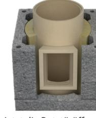
Montieren Sie jetzt die Putztüröffnung auf dem Kondensat Sockel in dem Mantelsteinen mit der zuvor vorbereiteten Öffnung und verkleiden diesen mit der mitgelieferten Mineralwolle.
