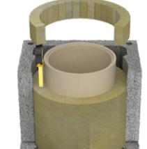
Bei dem Anbringen der letzten Mineralwolle ist darauf zu achten, dass ein Abstand von 5 bis 8 cm zwischen der Abdeckplatte und der Mineralwolle besteht, so dass die Luftzirkulation gewährleistet wird.
