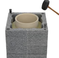
Bei Schornsteinen mit einer leichten Faserzementplatte montieren Sie die mitgelieferten Kunststoffdübel in die 4 Öffnungen von dem Leichtbetonmantelstein.
