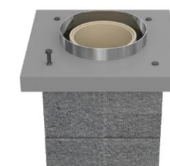
Die leichte Faserzementplatte legen Sie auf den Leichtbetonmantelstein und montieren diese mit den mitgelieferten Schrauben.
